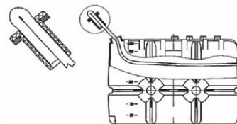
3. Закрепить отвод с помощью гайки.
